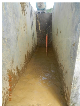
图 6 现场饱和软黏土制备
